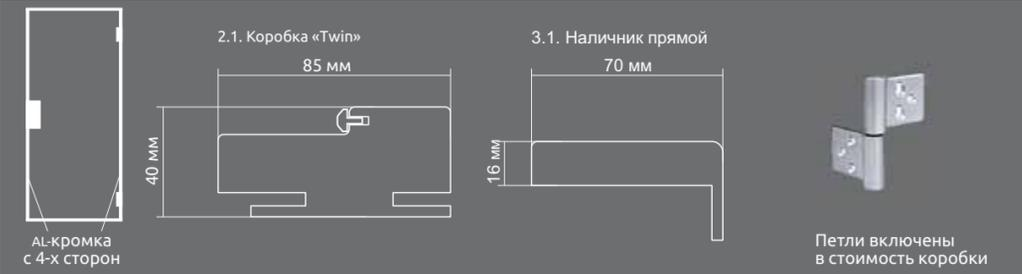
КОМПЛЕКТАЦИЯ резка под замок и петли ECLIPSE
