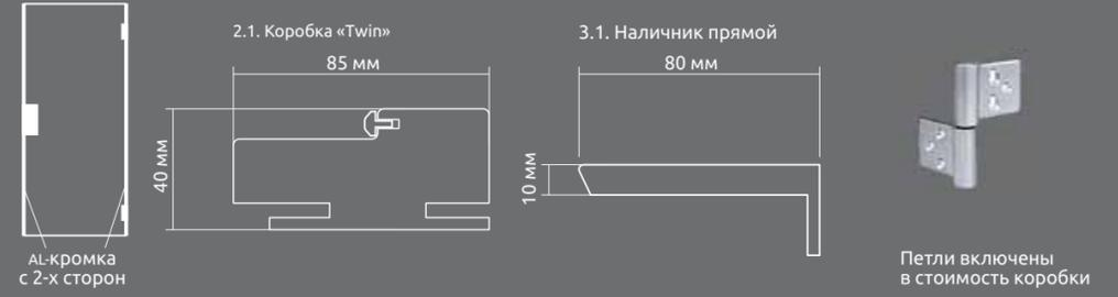
КОМПЛЕКТАЦИЯ резка под замок и петли ECLIPSE
